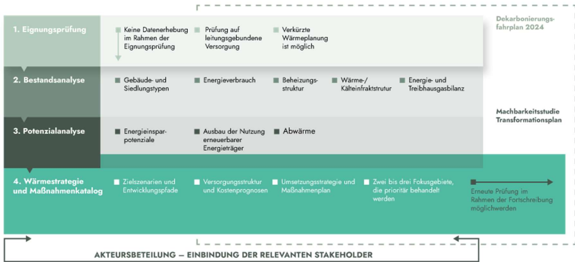
Abbildung 1: Ablauf der kommunalen Wärmeplanung, eigene Darstellung
